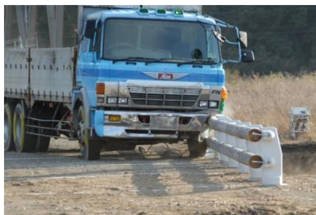
写真 5.1 b 10 年経過ビームを用いた衝突試験
