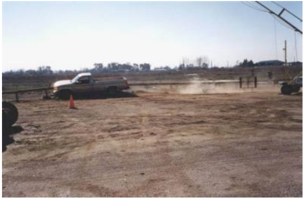
写真 2.2.1 b 衝突試験 (T20 タイプ)
