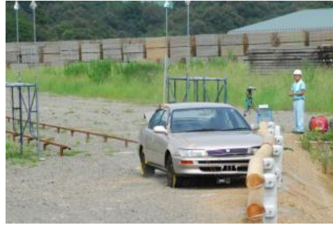
写真 3.1.1 ウッド Gr-P 型 3m スパン (Φ200) 社内試験実施状況
