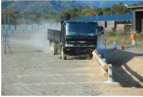
写真 3.1.1 ウッド Gr-P 型 3m スパン (Φ200) 社内試験実施状況
