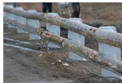
10年経過後の被害度2程度以下のビームを用いた実車衝突試験実施状況と、試験後のビーム
