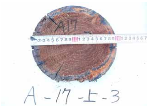
写真 2.2.2 浸潤度測定試験体（被害度 3）
