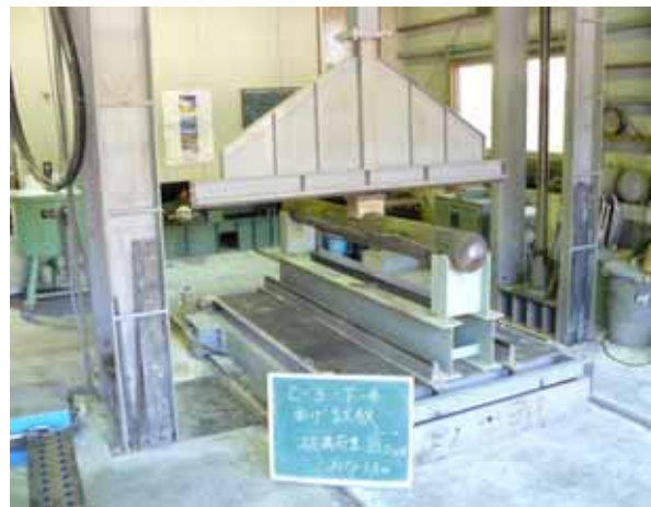
写真 2.1.3 腐朽ビームによる曲げ試験実施状況
