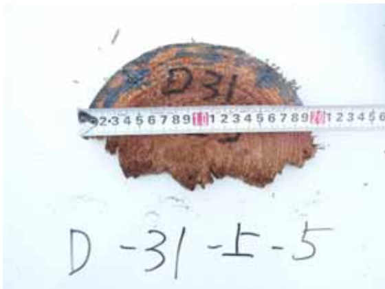
写真 2.2.4 浸潤度測定試験体（被害度 5）
