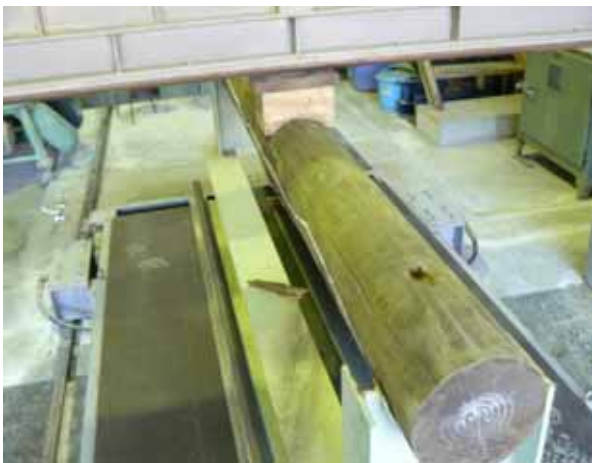
写真 2.1.3 腐朽ビームによる曲げ試験実施状況
