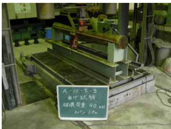
写真 2.1.4 腐朽ビームによる静的曲げヤング係数測定 (左) たて振動ヤング率測定 (右) 実施状況
