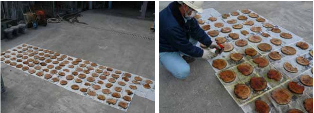
写真 2.2.1 腐朽ビームによる浸潤度測定用試験体（左）、試薬塗布状況（右）
