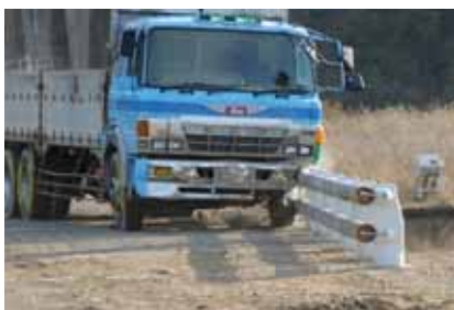
10年経過後の被害度2程度以下のビームを用いた実車衝突試験実施状況と、試験後のビーム
