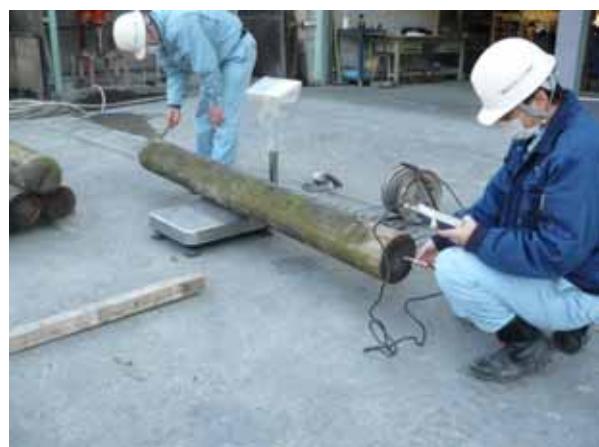
写真 2.1.4 腐朽ビームによる静的曲げヤング係数測定 (左) たて振動ヤング率測定 (右) 実施状況
