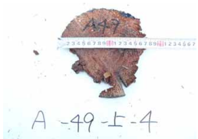
写真 2.2.3 浸潤度測定試験体（被害度 4）
