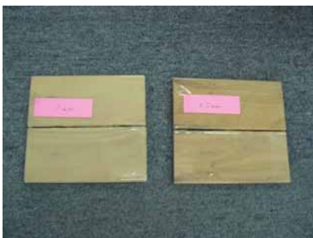
写真 2.2.6 試験前（左：1mm 右：0.5mm） 写真 2.2.7 試験後（左：1mm 右：0.5mm） （写真 2.2.7 の写真中央は、変色確認用の紫外線が当たっていない試験体裏面）
